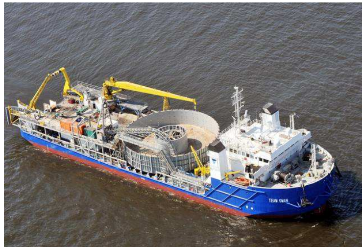
Illustration d'un navire posant des câbles - Source : Global Marine System
